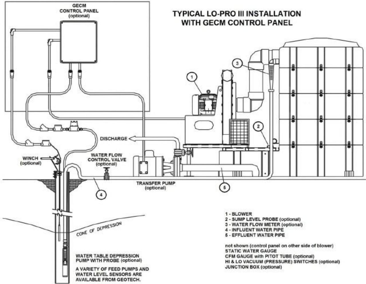
图 1-2 LO-PRO III系统带可选的GECM控制面板，出水泵和潜水泵
