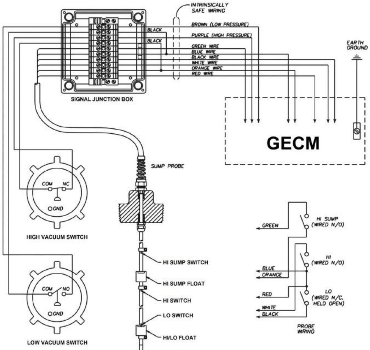
图 2-2 LO-PRO III底盘探头和HI/LO真空开关接线图。参考GECM手册或者GECM现场接线图以获得扩展设备连接到GECM的接线图
