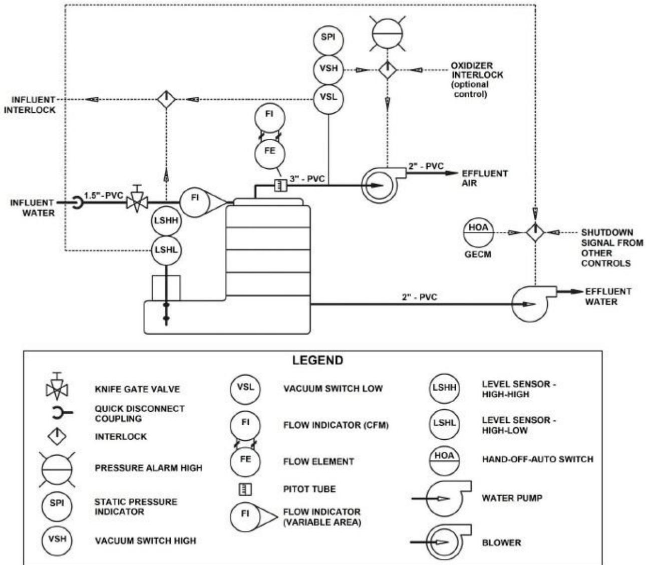
图 7-1 LO-PRO III系统处理和结构流程简图
