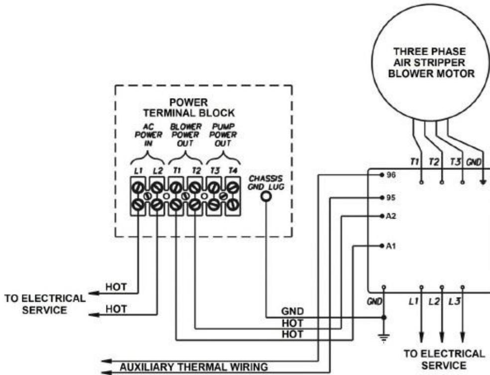
图 6-2 三相电源的鼓风机的基本线路
