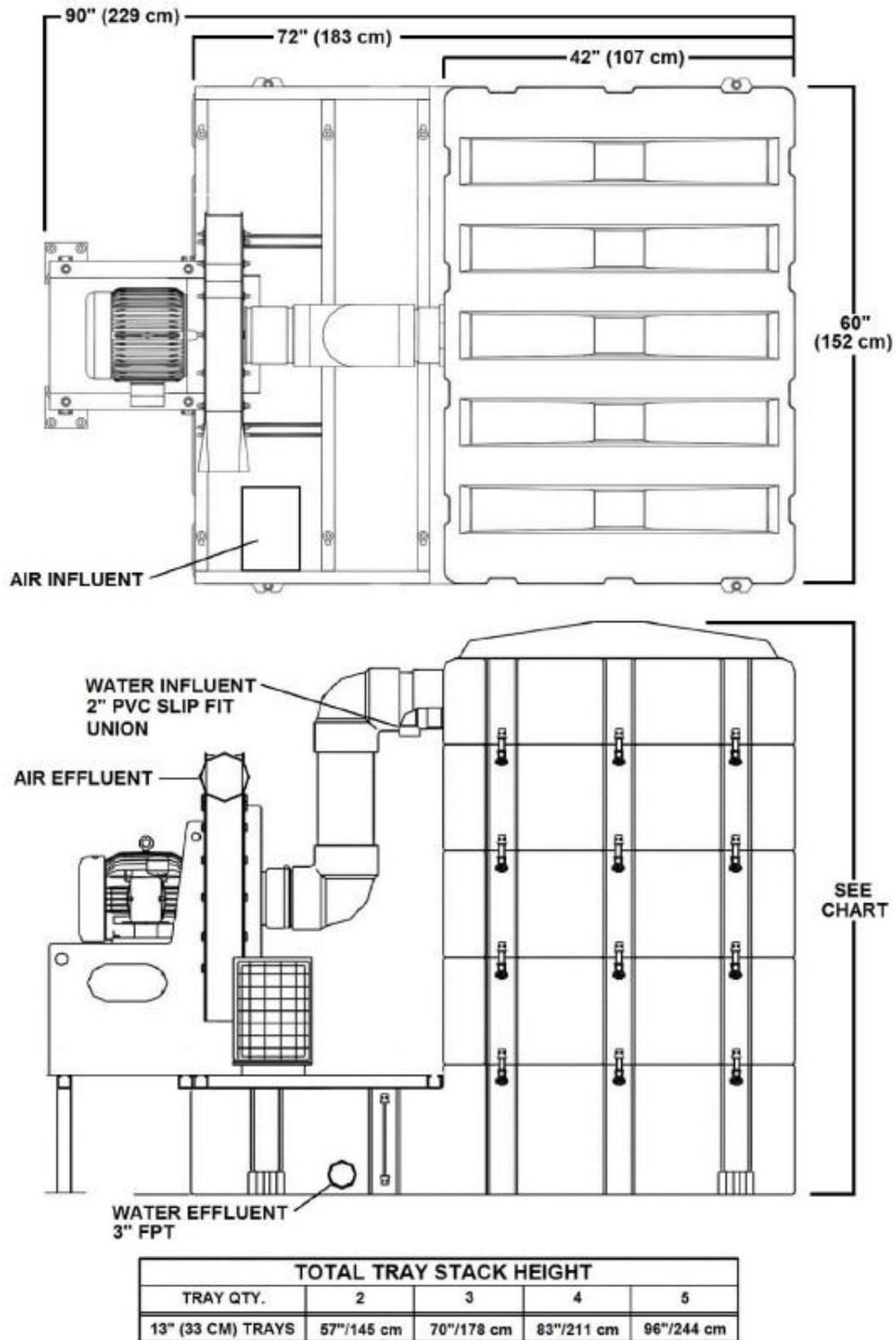
图 2-1 LO-PRO III 部件组装图（含系统尺寸，进出水管接头位置）
