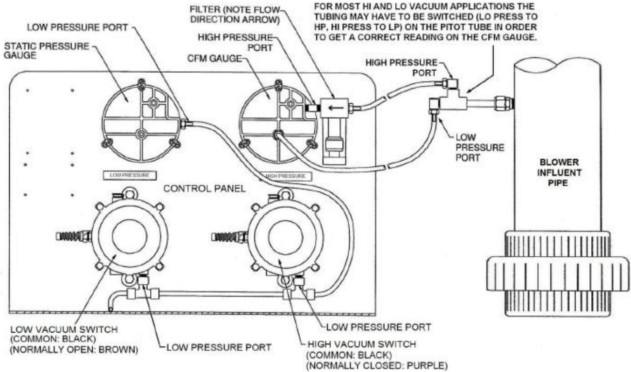
图 2-4 空气管线和皮托管安装到CFM压力表上
