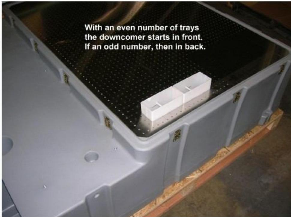
图 4-3 第一块孔板和导流板安装图
